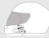
Ⓢ Branchez le câble USB du haut-parleur en l'enfonçant au maximum pour garantir une connexion fiable, ainsi qu'une bonne résistance aux éléments. Rangez la longueur de câble en excès sous le revêtement du casque, ou derrière les rembourrages de joue.
